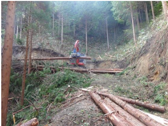
プロセッサによる間伐材の枝払い・造材（智頭町）
